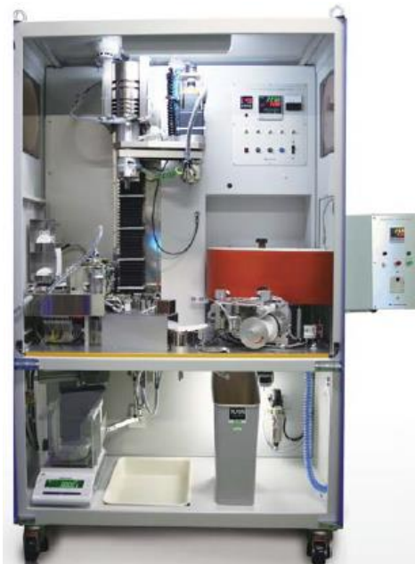
No.120-LABOT メルトフローインデックステスター (全自動)
