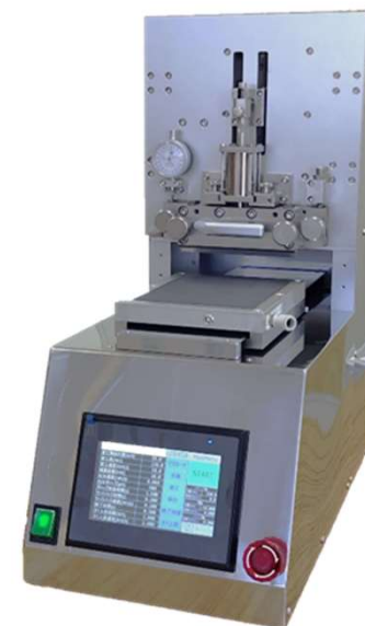
卓上スリットコーター(デモ機) 基板サイズ 100×100mm シリンジ方式
