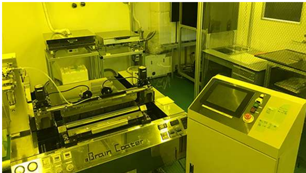
精密スリットコーター(デモ機) 基板サイズ 400×500mm
