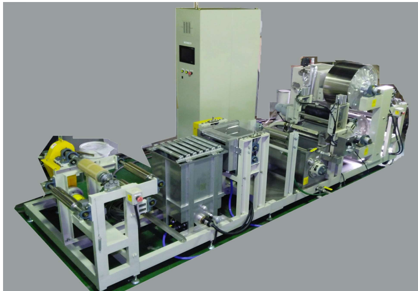
小型テスト機 巻出し／洗浄／絞り／乾燥／巻取り
