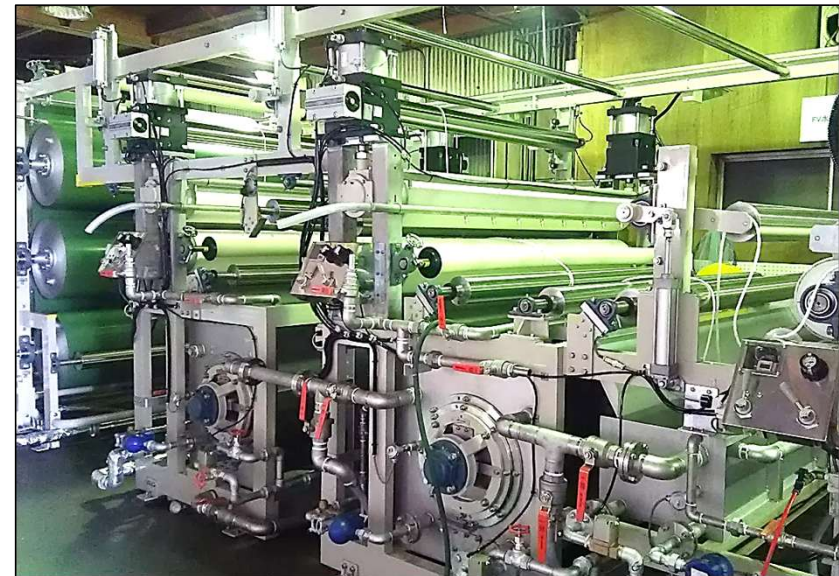
大型テスト機 巻出し／洗浄／絞り／乾燥／巻取り
