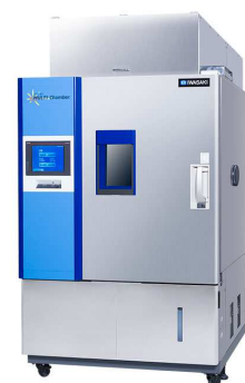
DIN/MIL-STD 規格対応試験機 (自動車コンポネント LV124など)
