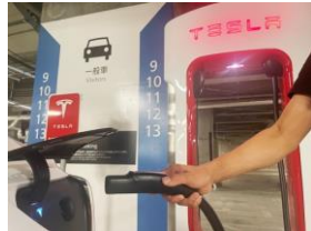
事前の操作なしに、充電口に挿し込むだけで充電が始まる
