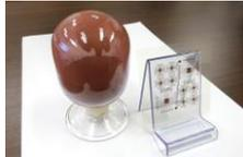
住友金属鉱山が開発した微粒銅粉（左）と導電性インクを印刷したフィルム状基材
