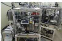
ペロブスカイト太陽電池自動作成システム
