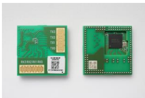
旭化成が量産するアンテナ一体型ミリ波レーダーモジュール
