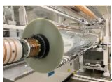
従来比3倍超の長尺COPフィルム。薄膜ですべり性も高い
