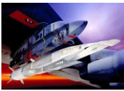
米空軍が開発中の極超音速試験機「X-51A」（下側の細長い部分）=米空軍提供
