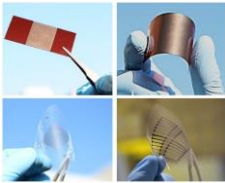
銅インクで印刷形成した配線（物材機構提供）
