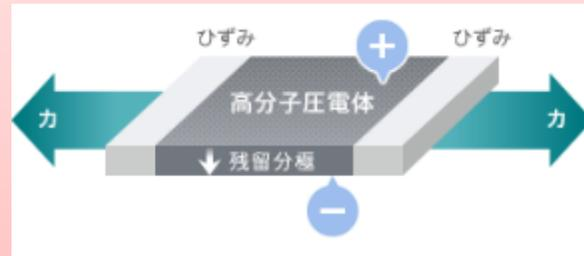
フィルムに力を加えてフィルムが変形
