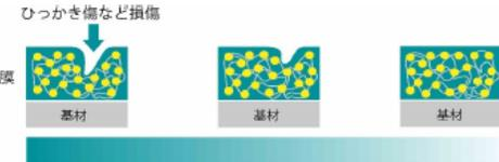
弾性エネルギーが復元力となって働き、経時で塗膜を元の状態に戻す
